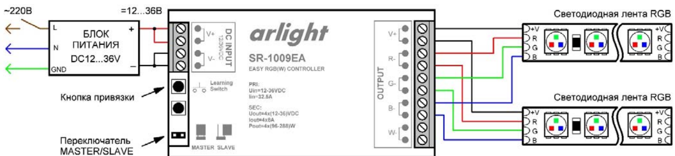
Схема 2. Подключение светодиодной ленты RGB.
