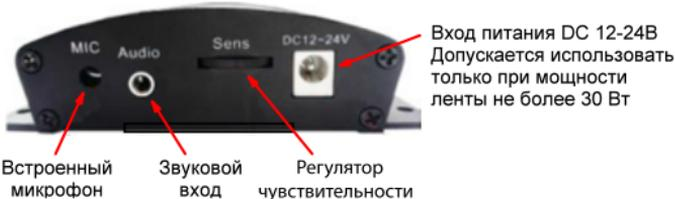
Рис.2. Назначение элементов, расположенных на боковой стороне контроллера.
