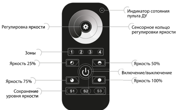
Рис.2. Назначение элементов управления пульта.
