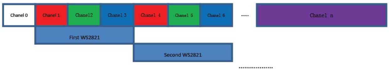
Диаграмма 1. Режим - Address By Pixel, установки - Begin Pixel=1, Adjoin IC Pixels NO.=0
