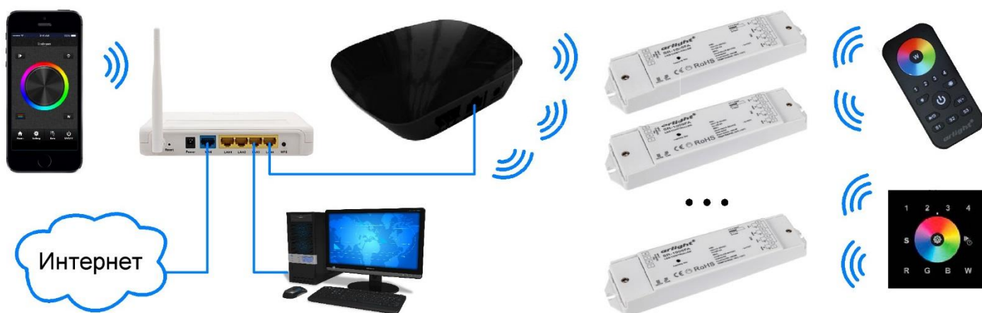
Рис.3. Подключение через роутер с использованием проводного соединения.
